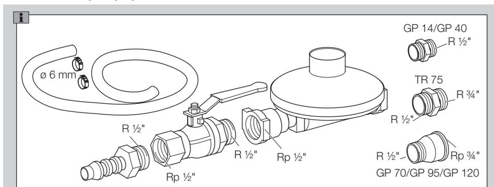
Manorreductor, válvula de bola, tubo flexible (longitud = 2 m), 2 abrazaderas para tubo flexible, racor doble R 1/2" para GP 14/GP 40, racor doble R 1/2"/R 3/4" para TR 75, pieza de reducción R 1/2" - Rp 3/4" para GP 70 - GP 120, para la conexión del grupo compacto de gas CG al suministro de gas, n.º de referencia: N70000014.
