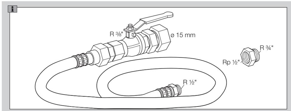
Válvula de bola y tubo flexible (certificado por DVGW, longitud = 2 m) para conectar el grupo compacto de gas CG al suministro de gas, n.º de referencia: N52990209. Pieza de conexión Rp 1/2" - R 3/4", n.º de referencia: N70000018.
