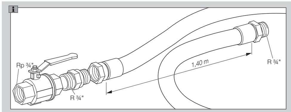
Set de conexión: conexión roscada R 3/4", longitud total = 1,50 m, n.º de referencia: N70000013.
