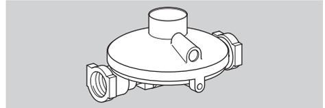
RECA 1,5 bar hasta 50 mbar, 2 conexiones de rosca interior 1/2", 10 kg/h, n.º de referencia: N52600023.
