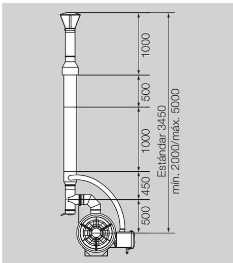
Este ejemplo de aplicación muestra la chimenea con la longitud de montaje máxima de 5 m.
